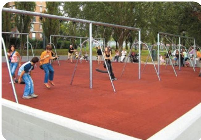
Le nostre pavimentazioni drenanti in granulo di gomma (SBR) con l'innovativo incastro a coda di rondine, (*MODELLO BREVETTATO*) garantiscono la massima tenuta tra gli incastri (4mt di perimetro= 6,20mt di connessione) ed una facile ed agevole posa in opera su tutte le tipologie di sottofondi, anche irregolari.
